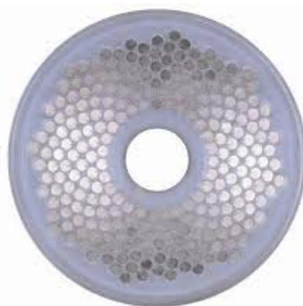
Fig. 7 Trasduttore HIFU a 251 elementi del sistema FEP-BY di China Medical Technologies ( http://www.chinameditech.com )
